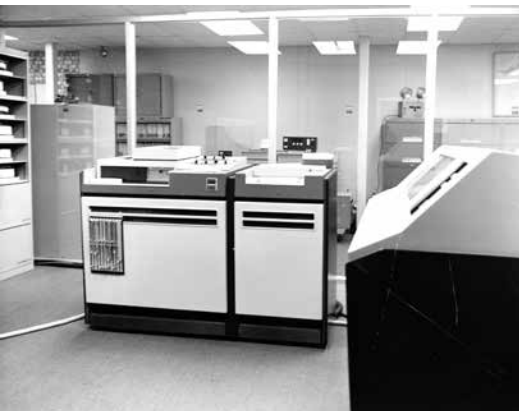
Centro de Cómputos (IT), c. 1974. NCR 101, segunda computadora de la empresa, utilizada para eliminar la tarjeta de ponchar y agilizar el proceso de nómina
