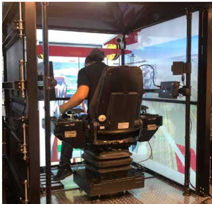
Simulador para adies- trar a los operadores en el manejo de contenedo- res, 2019
