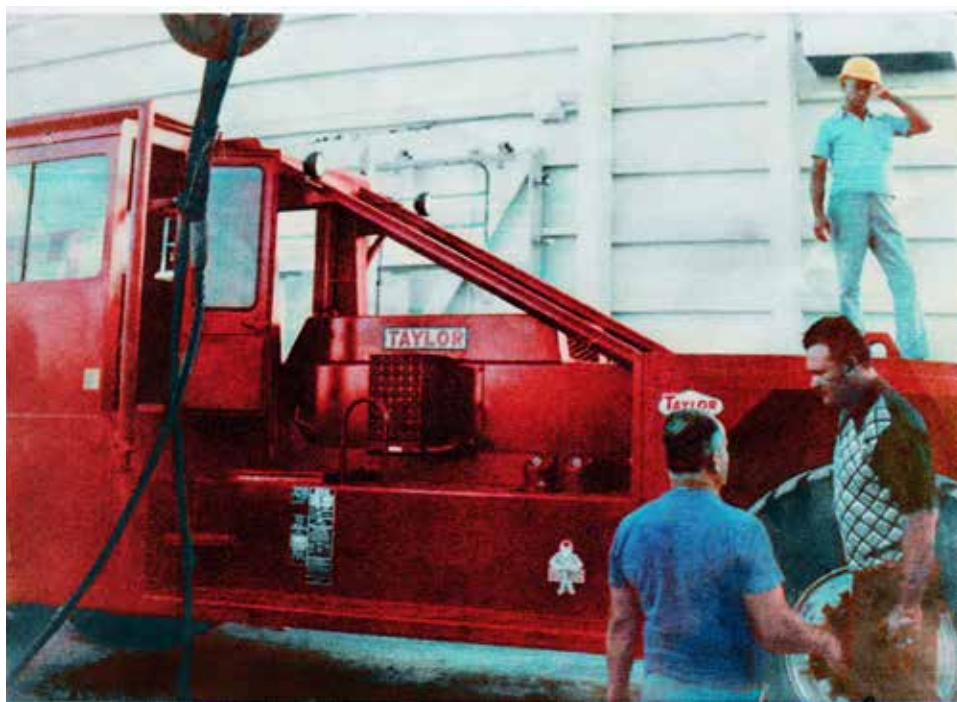
Rubén Puente y Rafael Muñoz, padre, frente a la grúa Taylor, el primer montacargas ("forklift truck") utilizado en Puerto Rico con capacidad para 52,000 libras y para mover contenedores de 20 pies, adquirido por Luis A. Ayala Colón en 1968
